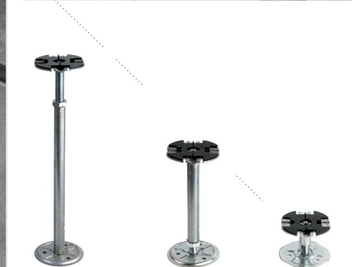
La estructura regulable de soporte en acero zingado se compone de pies y travesaños. Las bases se fijan a la solera mediante cola de resinas sintéticas. Los travesaños se fijan por presión a la estructura formando una cuadrícula de 600x600 sobre la que reposan las placas de suelo elevado.
